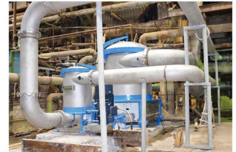
图9 俄罗斯色冷青纸业1000m/min牛皮纸系统使用的运达流送筛
